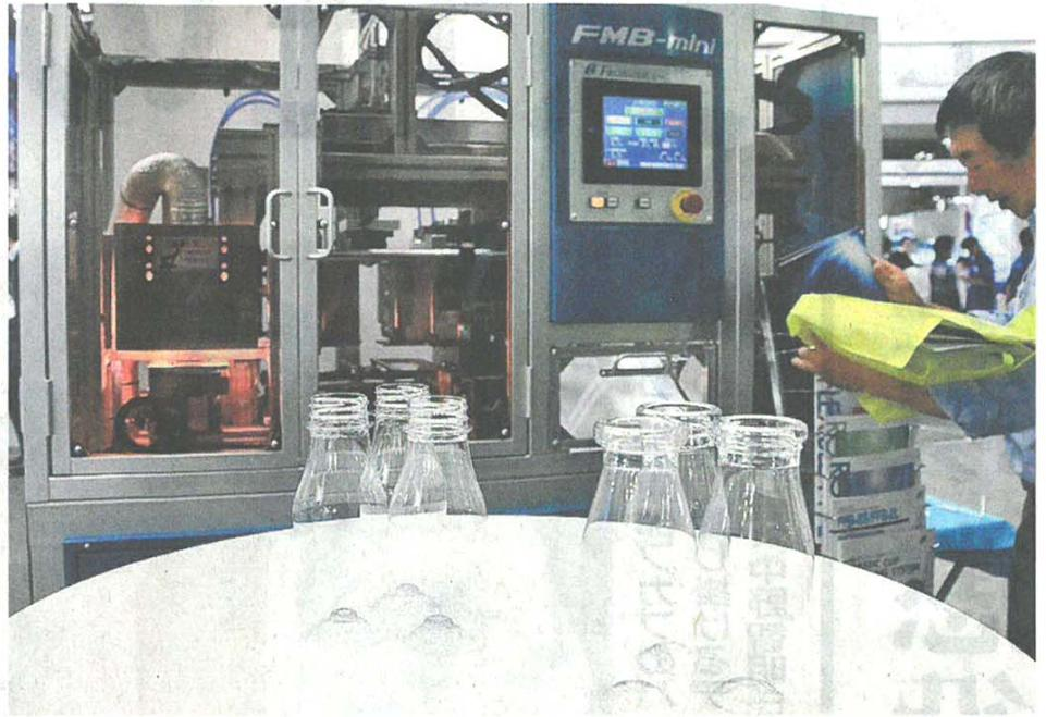
ペットボトル成形機製造のフロンティア(上田市)は、ガラス製の牛乳瓶に代わるペット容器の成形技術を開発した。同社のブロー成形機は近年、複数の大手乳業メーカーが飲むタイプのヨーグルト向
